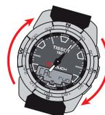
Gire el reloj más de una vuelta completa sobre una superficie horizontal (p. ej., una mesa) en un lugar en el que no existan perturbaciones magnéticas imprimiendo una velocidad de giro de alrededor de 30° por segundo.
